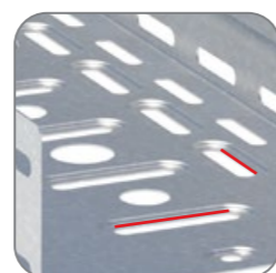
Продольная и поперечная подштамповка для увеличения площади охлаждения и придания дополнительной жесткости основанию лотка
