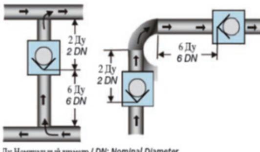
Турбулентный поток может привести к высоким нагрузкам на диске, в результате чего сокращается срок службы или клапан выходит из строя. После запуска системы убедитесь в отсутствии протечек в местах межфланцевого присоединения. Обеспечьте достаточное пространство вокруг клапана для будущих работ по техническому обслуживанию.
