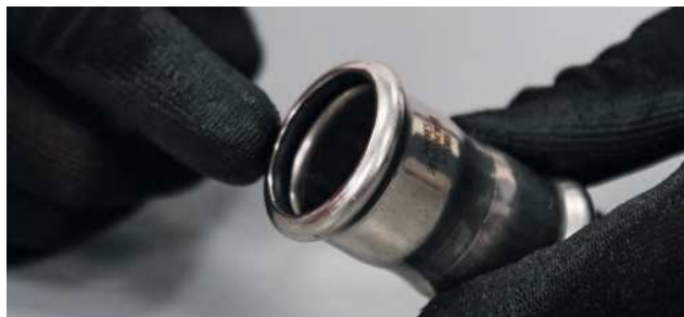
Рис. 30. Проверка уплотнительного кольца.
