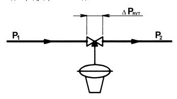
б) с входом редуцированного давления, отбираемого из трубопровода
